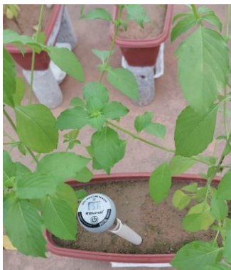
Figura 1: Vaso plástico do plantio dos manjericões com tensiômetro de punção.
