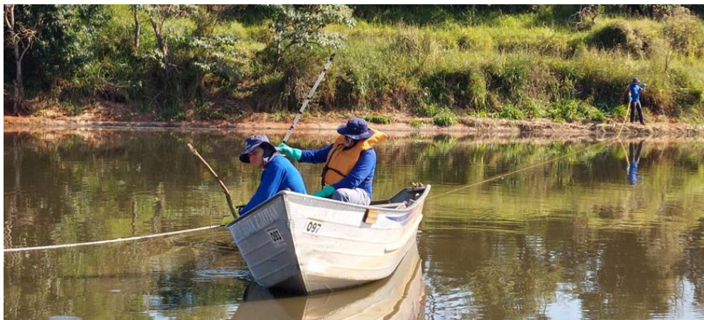
Figura 2: Levantamento batimétrico com coletor e medidor de perfil de sólidos.
