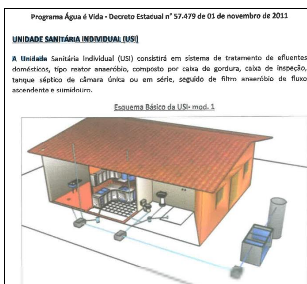
Figura 3 – Unidade Sanitária Individual - USI Fonte: São Paulo, 2021
