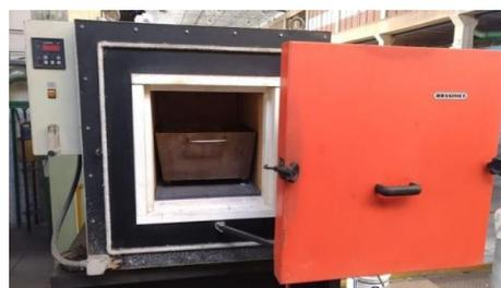
**Figura 12: Forno mufla para processamento térmico dos briquetes.**
