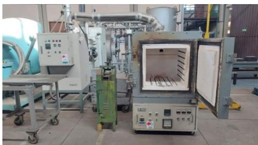
**Figura 10: Forno para higienização e desvolatilização do lodo**
