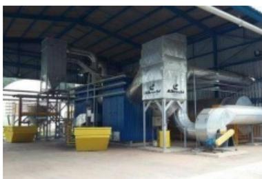
**Figura 6: Lodo ETE Ibirité - Sistema de secagem térmica.**
