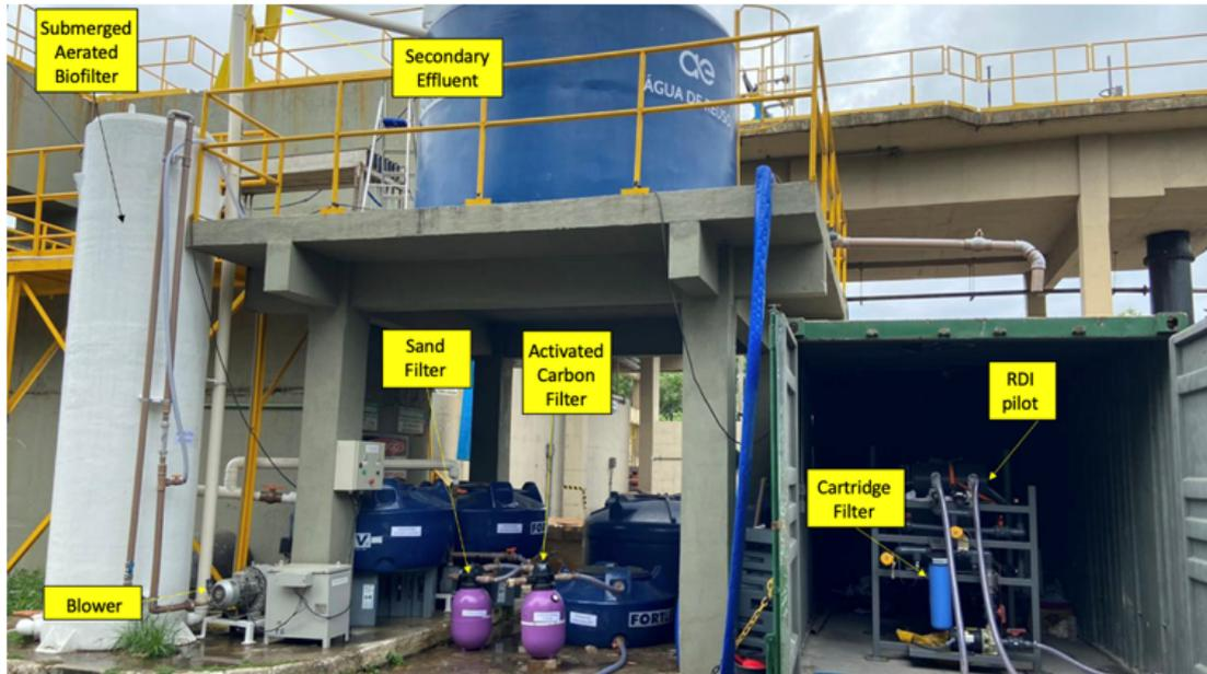
Figura 1 – Vista do aparato experimental: pós-tratamento (biofiltro aerado submerso, filtro de areia, filtro de carvão, filtro de cartucho e deionizador capacitivo RDI)
