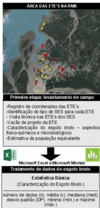
Figura 1: Primeira etapa do procedimento de investigação experimental para estimativa da geração de energia e emissão de metano produzido nas ETE's da RMB nos municípios de Belém, Ananindeua e Marituba para o SES-C e o SES-D.
