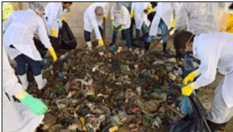
Figura 3: Materiais espalhados e realização da segregação dos RSU
