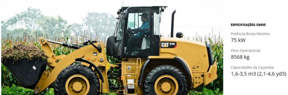
Figura 9: Pá carregadeira CAT 914k. Fonte: CAT.
