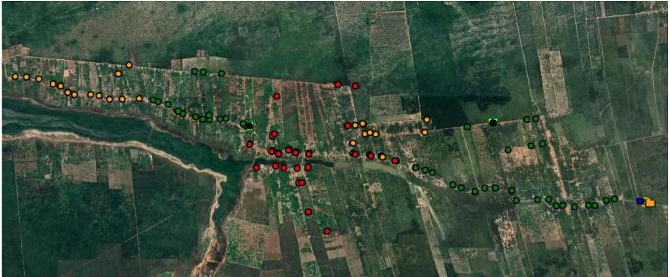
Figura 5 – Resultado da simulação da rede de distribuição de Jijoca (nós), Ceará - WSNO
