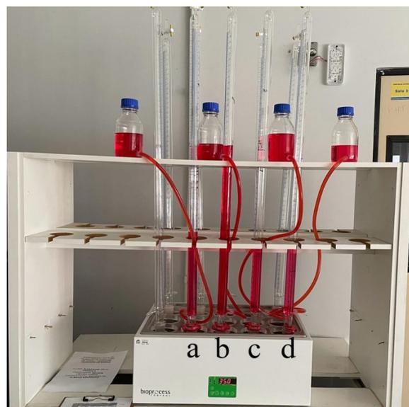
**Figura 1 - Sistema experimental para a medição da produção de biogás.**
