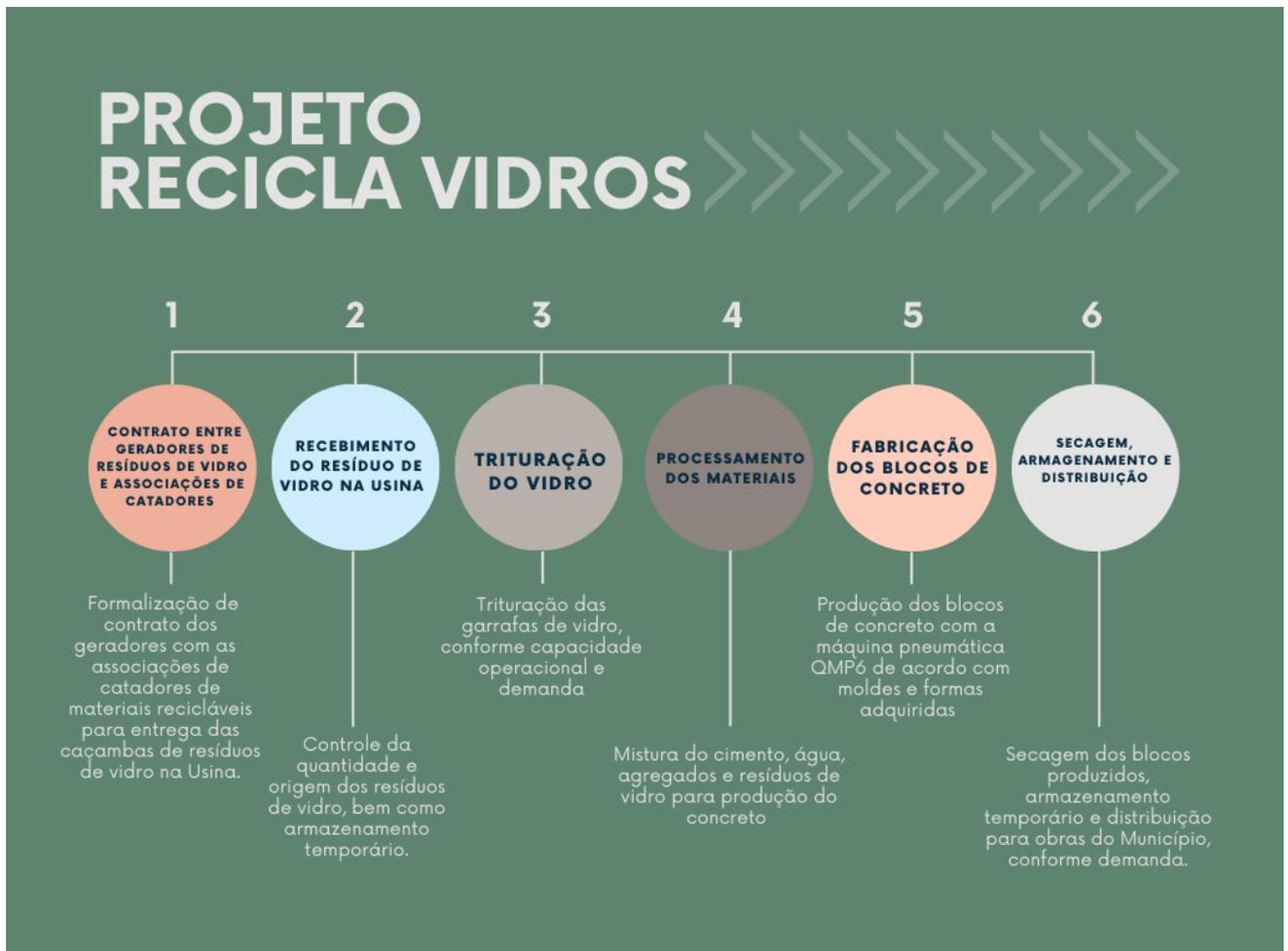
**Figura 2: Fluxograma do Processo de Reciclagem de Vidro e da Fabricação de Blocos de Concreto.**
