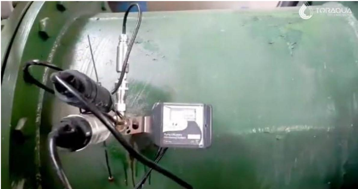
**Figura 2 - Vista do equipamento de medição termodinâmica de rendimento de bomba composto por monitor da bomba, transdutor de temperatura e transdutor de pressão.**
